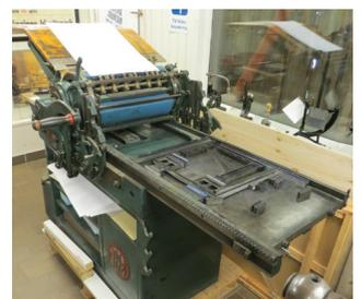
Hinten im Raum steht eine Korrekturpresse. Sie ist vor allem benutzt worden, um Abzüge zum Korrekturlesen oder für Kunden zum Gutheißsen zu machen. Sie ist die einzige Zylinderpresse des Museums. Alle übrigen sind Tiegeldruckpressen, die eine Metallplatte haben, die das Papier gegen die eingefärbte Druckplatte presst.
