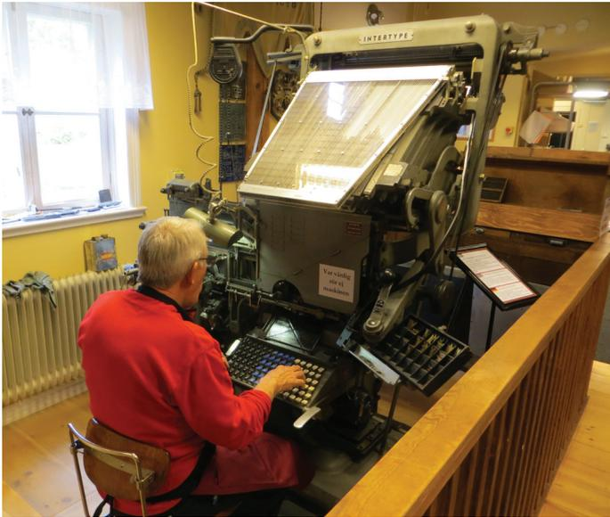
◀ Die Setzmaschine wurde von dem Deutschen Ottmar Mergenthaler konstruiert, der in den USA tätig war. Sie heißt Linotype. Die erste ihrer Art stand bei der New York Times 1886. Die erste, die nach Schweden kam, wurde bei Svenska Dagbladet 1898 installiert. Linköping bekam die erste Setzmaschine 1901 für Östgöta Correspondenten. Die Maschine im Museum ist vom Fabrikat Intertype und wurde um 1960 hergestellt. Durch die Einführung der Setzmaschine ging der Satz fünf oder sechs Mal schneller.
